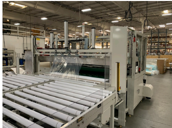
1306FF - Roll-Pac Machine with Single Fld Module Maquina de Enrollado con Modulo de Doblado Central
