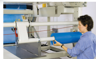
Easy replacement of boot film Fácil reemplazo del plástico de refuerzo
