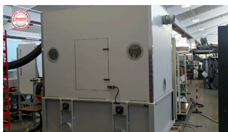
Mixer with a capacity of 2 m3 with external collecting silo Mezclador con capacidad de 2 m3 y tanque de coleccion
