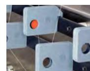
Parada por ruptura de hilo que realmente funciona! Nunca da una falsa señal. Siempre se detiene cuando un hilo de aguja o gancho se rompe. Doble filas de detectores de hilo permiten que el operador reestablezca detectores para diferentes patrones.
