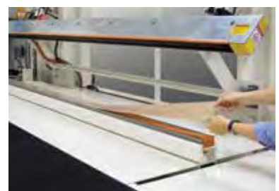
Simple replacement of PTFE tape Simple reemplazo de la cinta de PTFE
